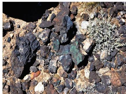
图11 铁银山铁矿构造热液型矿体铜矿化转石 (见孔雀石)
