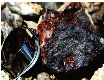
图 12 铁银山铁矿构造热液型矿体露头照 (见孔雀石、黄铜矿)
